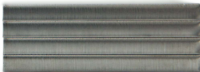
Tăieturi de clasa 2 pe oțel slab aliat de 6 mm
