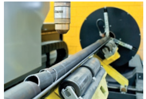
Taglio tubo a mandrino CNC sincronizzato Synchronized CNC pipe cutting lathe
